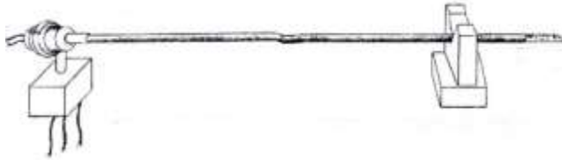
सलाई पर लगा अति-सम्वाहकशील (सुपर कंडकटिव) सेरामिक
